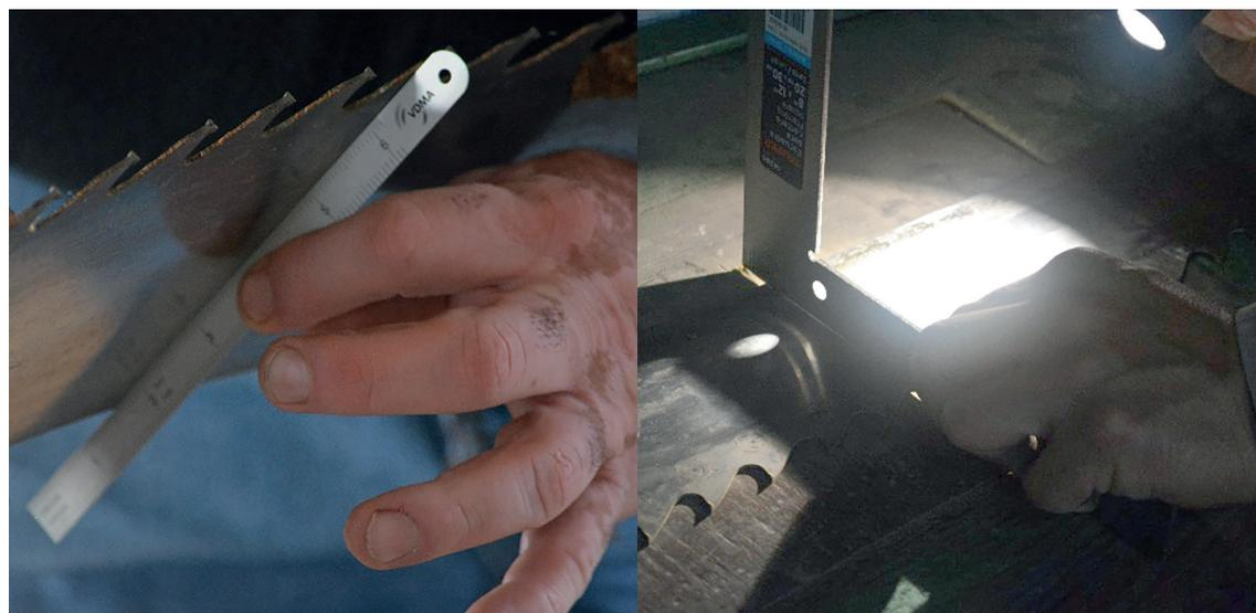
**Figura 49.** Inspección de sierras circulares y daños.
