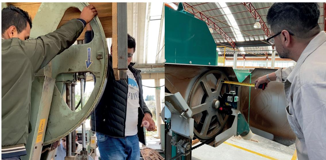
**Figura 55.** Criterios de alineación de volantes.
