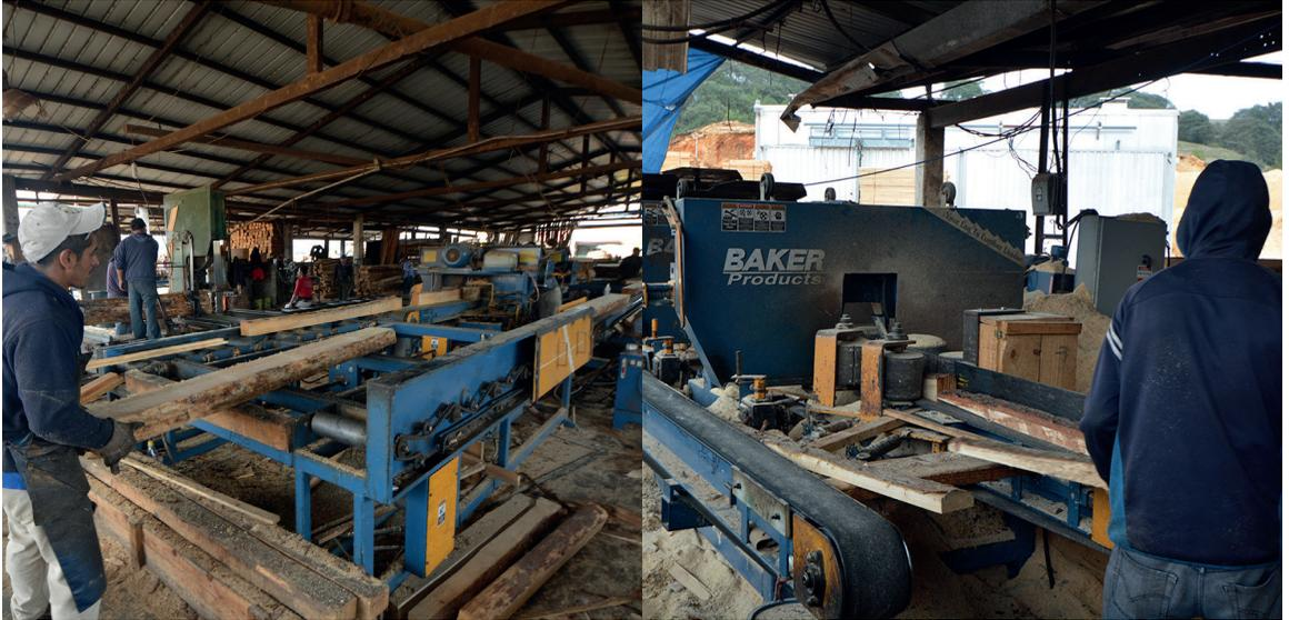
**Figura 33.** Armadora de tarimas y tarimas armadas.
