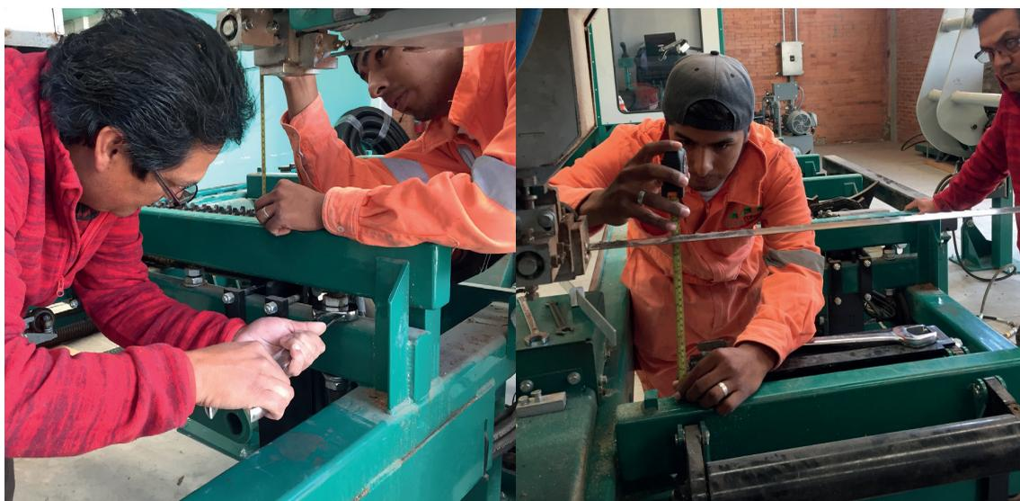
**Figura 52.** Inspección y alineación de carros porta trozas.
